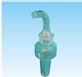
インパクタ付10mL型 ダスト捕集器と吸引ノズル
