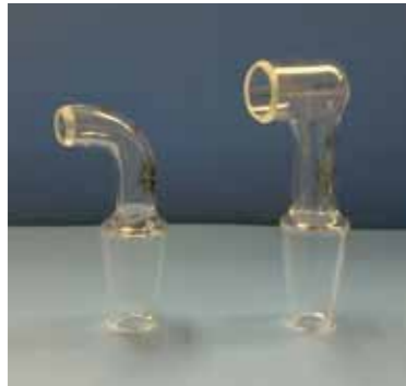
ガラス製吸引ノズルの形状 写真左 3φ~16φまで 写真右 17φ~24φまで
